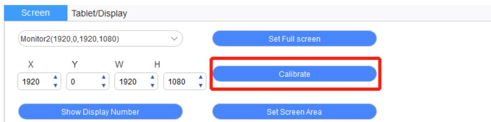
Si plusieurs moniteurs sont utilisés en mode Étendu, vous devez sélectionner la zone de travail de l'appareil sur l'interface du pilote pour la mapper sur le moniteur correspondant.
