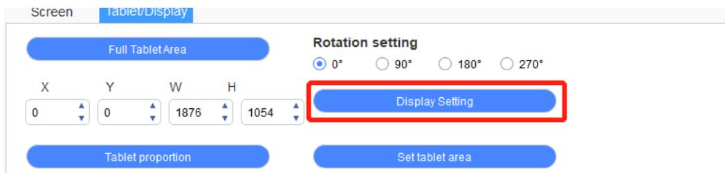
Configurez n'importe quelle partie de la zone de travail de l'appareil à mapper comme zone d'affichage de l'écran. Le pilote propose quatre modes de sélection :
