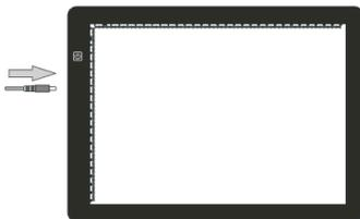
b) Sortez la tablette et le câblage USB, connecter le port d'USB à ceux d'ordinateur. Si un adaptateur est concerné, pénétrez le port A dans la prise correspondant de l'adaptateur, et connecter l'adaptateur dans une prise de CA. (uniquement pour l'alimentation d'USB)
