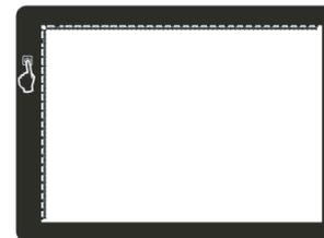
(4) Régler la luminosité: la tablette lumineuse allumée, touchez le bouton tactile continuellement, faisant accroître/baisser progressivement la luminosité de la tablette. Quand vous avez choisi la luminosité idéale, interrompez la touche du bouton et la tablette sera réglée jusque là.
